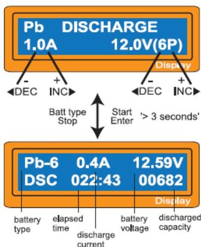
Nastavte běh vybíjení nalevo a konečné napětí napravo. Běh vybíjení je vymezen od 0.1 do 1.0A.
