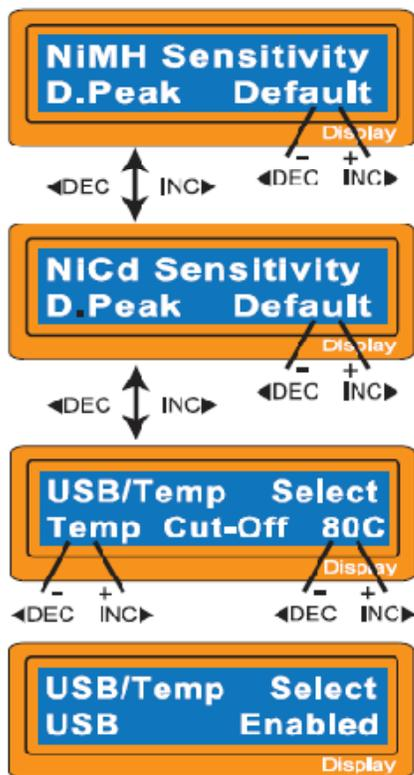
Toto ukazuje spouštěč napětí? pro automatické ukončení nabíjení? NiMH a NiCd baterií. Efektivní oblast hodnot je od 5 do 20mV na článek. Pokud je spouštěč napětí je nastaven výše, je zde nebezpečí přehřátí baterie; pokud je nastaven níže, je zde možnost předčasného ukončení. Prosím, zkontrolujte technický popis baterie. (NiCd standard: 12mV, NiMH standard:7mV)
