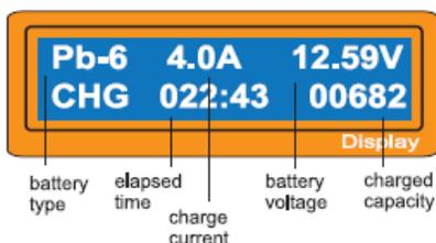
Obrazovka ukazuje stav nabíjení. K nucenému zastavení, stiskněte Batt type/stop tlačítko. Slyšitelný zvuk značí, že jste ukončili operaci.
