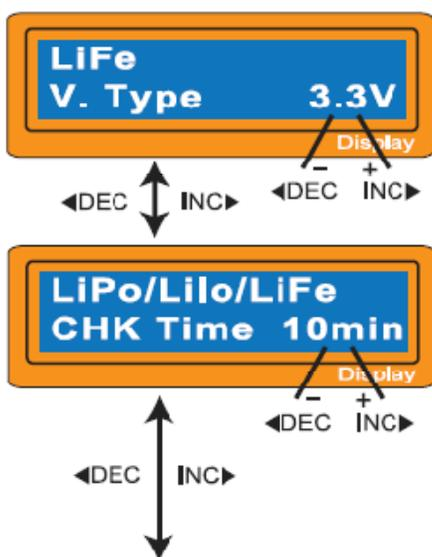
Obrazovka ukazuje přibližné napětí baterie lithium. Jsou zde tři druhy baterie; LiFe(3.3V), LiIo(3.6V) nebo LiPo(3.7V). Toto je velmi důležité a tak musíte nakládat s baterií opatrně a nastavovat ji správně. Pokud se hodnota odlišuje od správné hodnoty baterie může explodovat během nabíjení.
