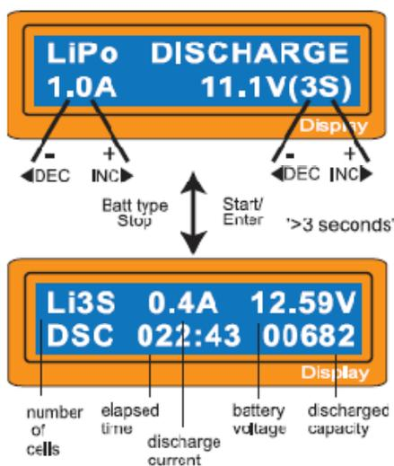
Hodnota běhu vybíjení na levé straně obrazovky nemůže přesáhnout 1C aby byla zajištěna maximální bezpečnost a konečné napětí na pravé straně by nemělo být pod úrovní napětí, která je doporučena výrobcem baterie k vyvarování se hlubokému vybití. K zahájení vybíjení, stiskněte Start/enter tlačítko na více než 3 vteřiny.
