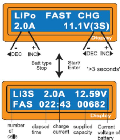
Můžete nastavit běh nabíjení a napětí baterie během nabíjení. Když stisknete Start /enter tlačítko, potvrzení o napětí bude ukázáno. A poté, pokud potvrdíte napětí a běh, stiskněte Start/enter tlačítko opět k zahájení nabíjení.
