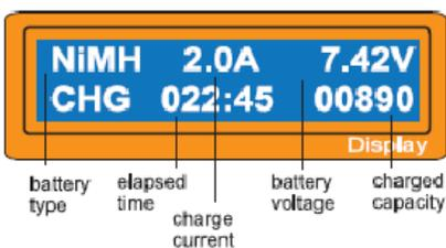
Obrazovka ukazuje stav běhu nabíjení. K zastavení procesu, stiskněte Batt Type/Stop tlačítko. Slyšitelný zvuk značí, že jste ukončili proces.
