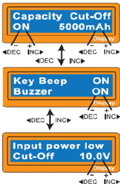
Tento program nastavuje maximální nabíjecí kapacitu, která bude poskytována baterii během nabíjení. Pokud delta-pack napětí není odhaleno? a ani časovač bezpečnosti uplyne z nějakého důvodu, tato funkce automaticky zastaví proces na vybrané kapacitní hodnotě.
