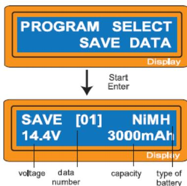
Nastavování hodnoty parametru na obrazovce neovlivní nabíjení nebo vybíjení. Pouze ukážou popis baterie. Následující obrazovky budou automaticky zobrazovány přesně aby souhlasily s typem baterie, který jste nastavili. Příklad ukazuje baterii NiMH, 12tičláňková a 3000mAh capacity.
