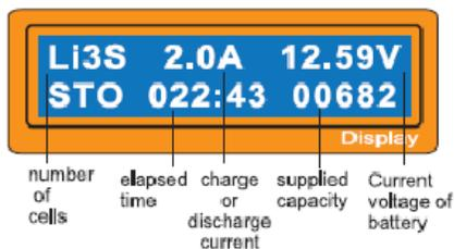
Obrazovka ukazuje současnou situaci během nabíjení. K zastavení nabíjení stiskněte Batt Type/Stop tlačítko.
