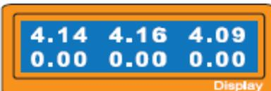
Použitím individuálního síťového kabelu do baterie, můžete zkontrolovat individuální napětí každého článku baterie. Když připojíte kabel do portu na pravé straně nabíječky, program ukáže napětí každých článků a to maximálně 6 článků v sekvenci. K zužitkování této funkce, baterie
