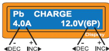
Nastavte běh nabíjení na levé a přibližné napětí baterie na pravé straně. Běh nabíjení vymezen od . do . A a napětí by mělo souhlasit s baterií během nabíjení.??? Proces zahájíte stisknutím Start/enter tlačítka na více než vteřiny.
