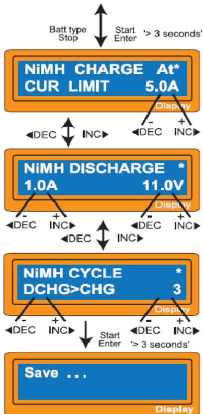
Nastavte běh nabíjení pro manuální nabíjecí mód, nebo limit běhu pro automatický nabíjecí mód. Každý mód může být přepnut stisknutím INC a DEC tlačítkem stejně, když oblast běhu bliká.
