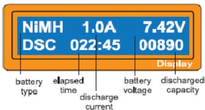
Obrazovka ukazuje stav běhu vybíjení. Můžete měnit běh vybíjení stisknutím Start/enter tlačítka během procesu. Pokud jednou změňte hodnotu, uložíte ji stisknutím Start/enter.
