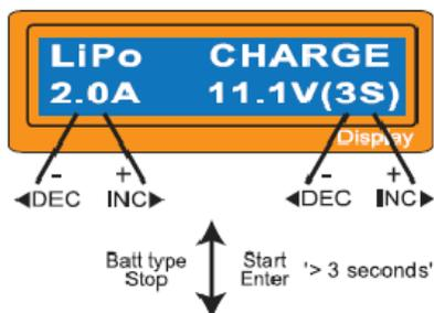
Levá strana prvního řádku ukazuje typ baterie, kterou máte vybranou v uživatelském nastavení. Hodnota na levé straně druhého řádku nastavuje nabíjecí běh a hodnota na pravé straně druhého řádku nastavuje napětí baterie. Po nastavení běhu a napětí stisknutím Start/enter tlačítkem na více než 3 vteřiny k zahájení procesu (nabíjecí běh:0.1~5.0A, napětí:1~6 serií.)
