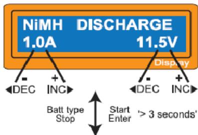
Nastavený běh vybíjení na levé straně a konečné napětí na pravé. Běh vybíjení je vymezen od 0.1 do 1.0A a konečné napětí od 0.1 do 25.0V. K zahájení procesu, stiskněte Start/enter tlačítko na více než 3vteřiny.
