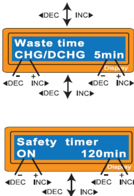
Baterie, která je na cyklickém procesu nabíjení a vybití může se často zahřát po nabíjecí nebo vybíjecí fázi. Program může vložit čas odkladu, aby se objevil? po každém nabití a vybití k tomu, aby bylo dovoleno baterii mít adekvátní čas ke zchlazení před započítím dalšího procesu. Oblast hodnot je od 1 do 60 min ut.
