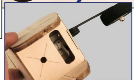
Vloďte řízení předních kol do části, která byla nainstalována v kroku 9, upevněte horním šroubem.
