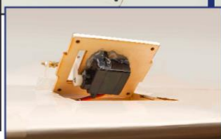
Nainstalujte servo klapky a křídélka, jak je znázorněno na obrázku, připojte rameno kormidla a křídélko, spojte rameno kormidla a křídélko pomocí ocelového táhla ve tvaru Z a zajistěte ji přes rychlospojku.
